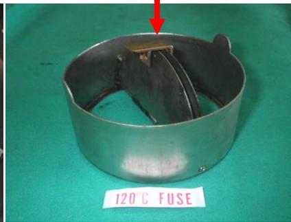
温度フューズが溶断すると、バネの力でダンパの羽根が開く
